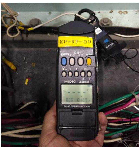
圖11 量測#1 Bus PT中性點接地線
