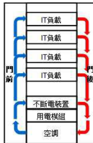
圖 7 智慧配電櫃空調氣流示意圖
