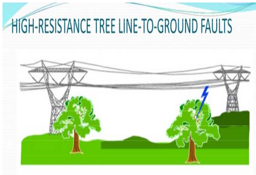
圖 33 樹木引發線路高阻抗接地故障圖 (資料來源：網路)
