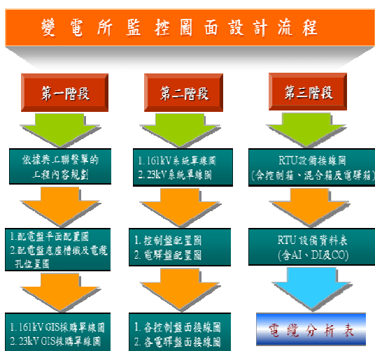
圖 1 變電所監控設計流程
