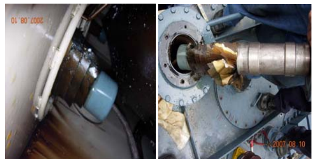
圖1 #2主變壓器S相套管下磁套故障
