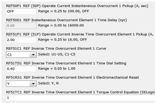
圖 23 保護電驛中性點接地過流延時(51Z)設定圖
