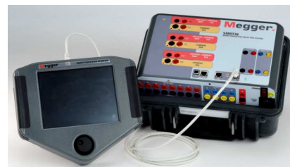
圖 26 Megger SMRT36 電驛測試儀器外觀圖
