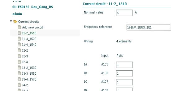
圖21 填入適當的電流及匝比
