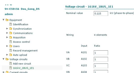
圖20 填入適當的電壓及匝比
