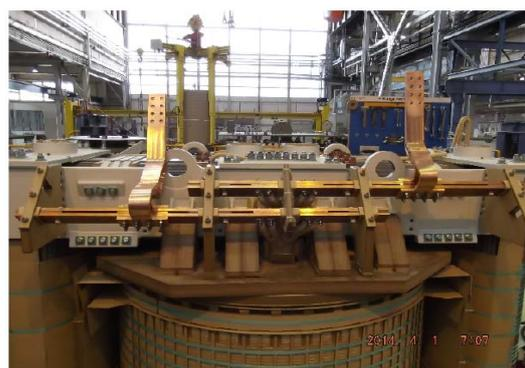
圖 15 主變 B 相內部接線正確為減極性
