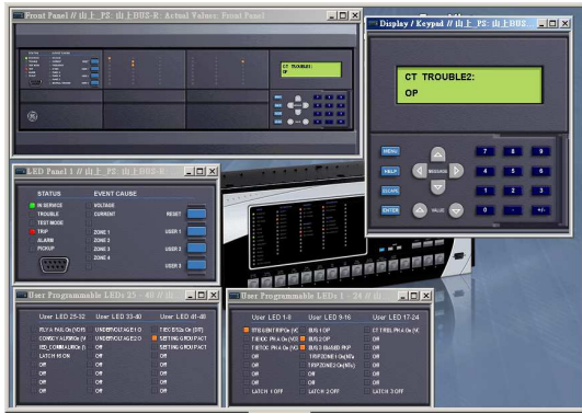
圖 43 山上 P/S BUS-R 相電驛動作 LED 顯示情形圖
