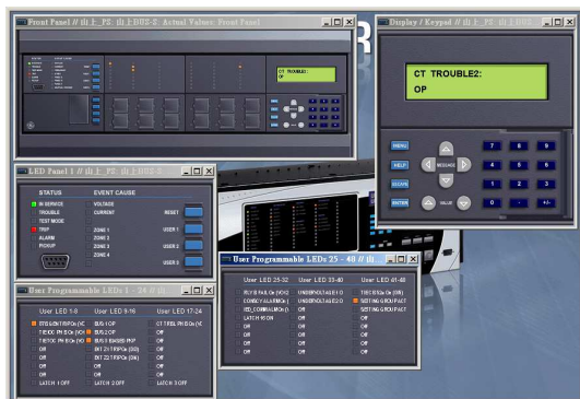
圖 45 山上 P/S BUS-S 相電驛動作 LED 顯示情形圖
