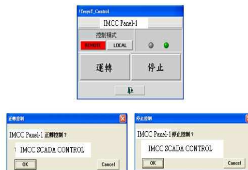
圖 12 IMCCs SCADA 遠方兩段式控制圖
