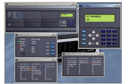
圖 47 山上 P/S BUS-T 相電驛動作 LED 顯示情形圖
