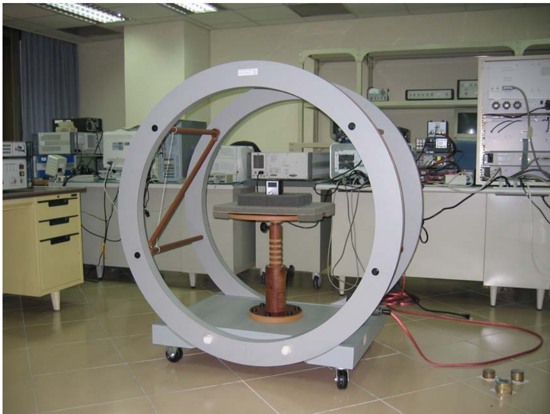
圖八 工頻磁場試驗方式
