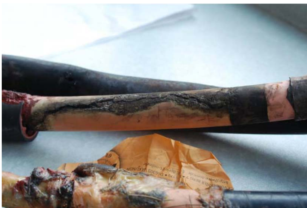
圖 9 EPR 電纜直路接續匣表面電爬
