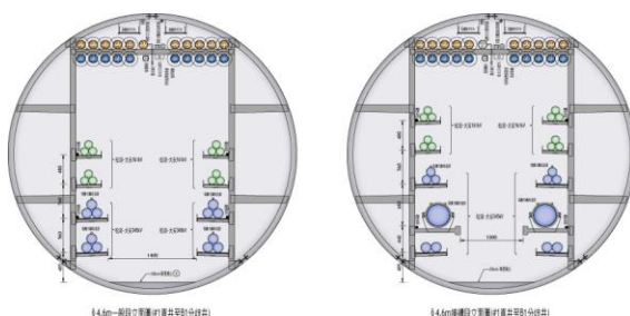
洞道中超高壓地下電力系統之設計
