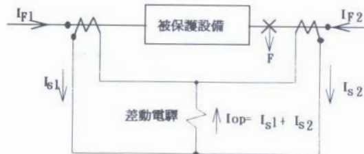
圖三 內部故障時電流分布情況
