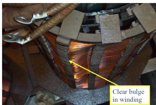
圖八 變壓器線圈受損照片
