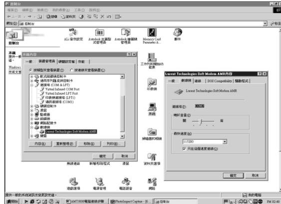
8-1.透過微波電話線以撥接方式連線之設定:首先進入[控制台]→[系統]→[數據機]頁面中，更改連線速度為[115200]，注意不同電腦主機的數據機所佔用的 COM Port 資源不一定相同，如(圖七)。
